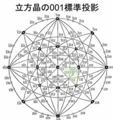
図 2.9: 立方晶の 001 標準ステレオ投影
